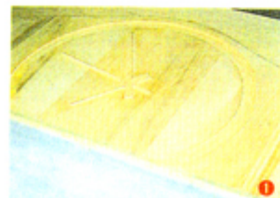
●(スウォッチ)のポスター制作工程、ポスターの表面をレリーフ状にするため、木型を起こし、真空成型した [7点とも、浦和市・モダンプラスチック(株)]
